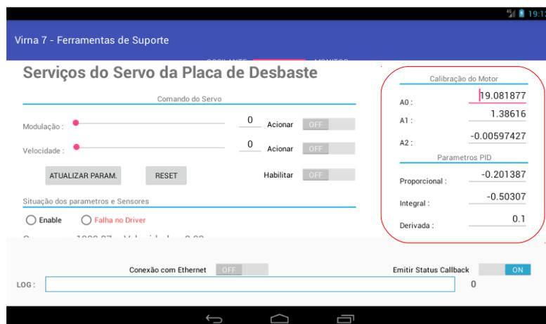
Figura 20: Calibração do Servo do Instrumento
